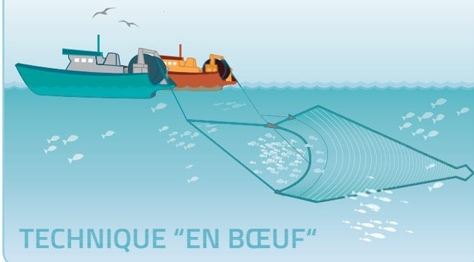
Le chalut est un filet remorqué en forme d'entonnoir. Lorsqu'il évolue en pleine eau, c'est le chalut pélagique. Sur le fond, c'est le chalut de fond.
